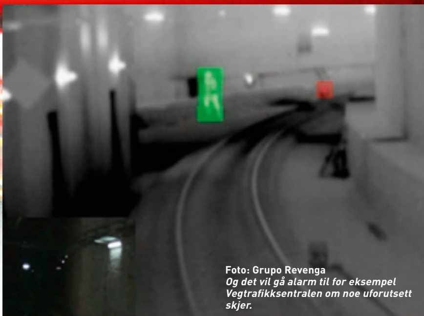
Foto: Grupo Revenga Kontrast mellom hva et vanlig kamera vil fange opp sammenlignet med et IR-kamera.
